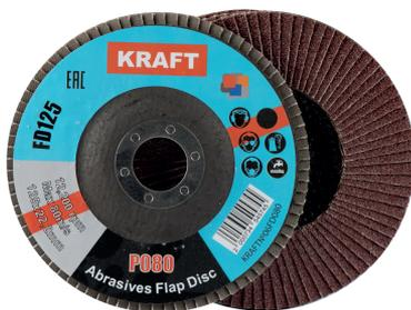
Зачистные лепестковые диски состоят из тарелки из стекловолокна и прикрепленных абразивных лепестков, наложенных друг на друга с нахлестом. Применяются для шлифования и обработки металла, алюминия и цветных металлов, латуни и бронзы, пластмасс и полиэфиров, красок и лаков, дерева, стали. Незаменимы при обработке сварных швов, удаления заусенцев и ржавчины на стали и цветных металлах, очистки отливок, обработки металлических краев, шлифования сторон и углов.
